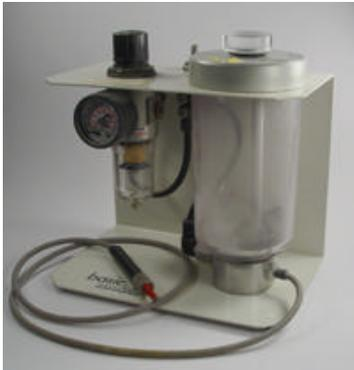
Das Präparieren von Fossilien mit der Sandstrahltechnik ist in den vergangenen Jahre immer beliebter geworden. Diese Freilegung hat gegenüber chemischen Methoden den Vorteil ohne Rückstände einsetzbar zu sein, und auch im Gegensatz zur mechanischen Freilegung mit Druckluftmeißeln ist sie schonender. Aus diesem Grund hat sich Peter Jörres Gedanken gemacht ein Sandstrahlgerät im Eigenbau anzufertigen, das den Geldbeutel schon aber ähnlich gute Resultate bringt wie ein „Profigerät“.
